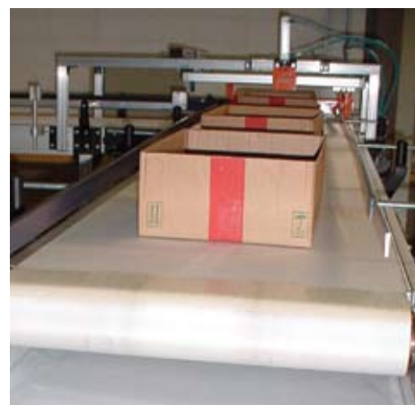
Transportador de correia para caixas
