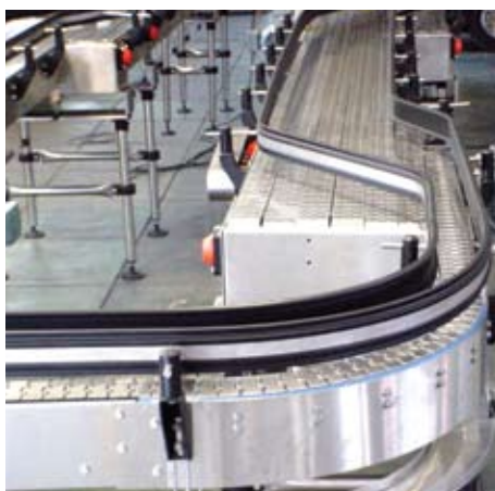
Transportadores em aço inox (mesa de acúmulo)
